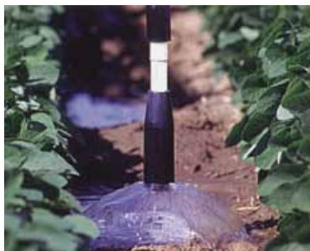
Если опустить вниз насадки, то с помощью системы орошения Pivot Центральная наряду с дождевальным орошением можно проводить также поверхностное орошение.
